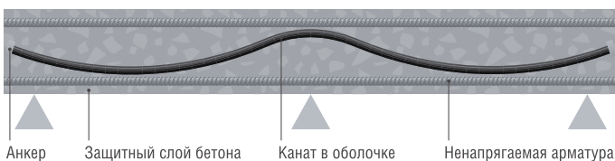
РИС. 1. ПРИНЦИПАЛЬНАЯ СХЕМА РАСКЛАДКИ КАНАТА В КОНСТРУКЦИИ.
