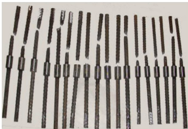
Рис.1: Образцы механических соединений арматуры после испытаний на разрушение до разрыва
